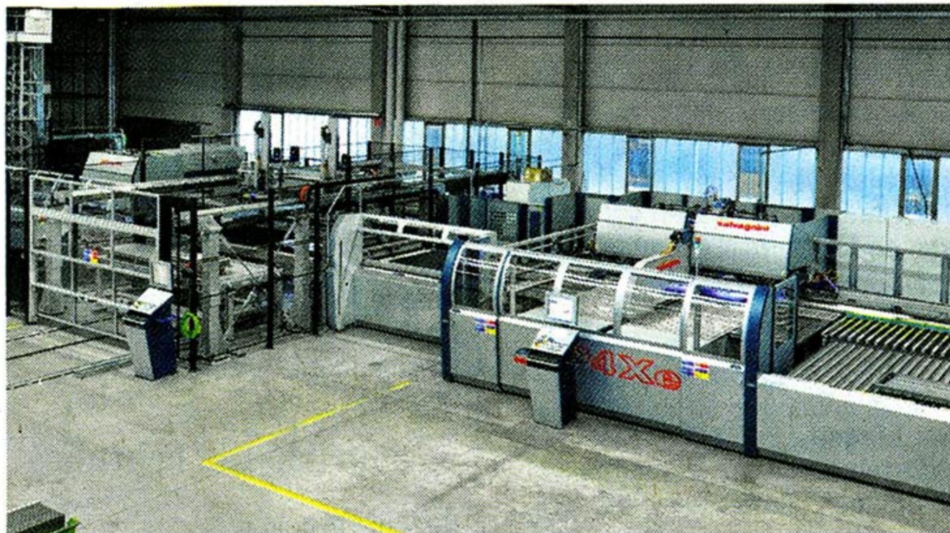
Das Foto zeigt die neue Anke-Stanz-Biegelinie mit Lagerturmanbindung.
